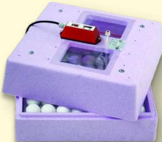
Thermoplastik-Brutmaschine mit 2 großen Sichtfenstern. Ausstattung: Thermostat mit digitaler Temperaturanzeige, 48 Watt-Heizelement, 230 Volt -Stromanschluss. Die Bruteier liegen auf einem Kunststoffrost. Unter dem Rost befinden sich drei verschieden große Wasserrinnen.
