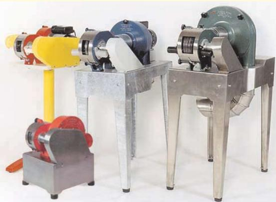
TR-1 mit 6 Rupfscheiben, TR-2+3 mit 7 Rupfscheiben und TR-4 mit 11 Rupfscheiben. TR-1 und 2 nur für Kleingeflügel geeignet. Mit TR-2 und 3 rupfen Sie ca. 30-35 Hühner pro Stunde - mit der TR-4 ca. 40-45 Hühner pro Stunde.
