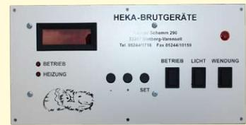
Die Temperatur lässt sich in 1/10°C digital vorwählen. Der Wert wird stromausfallsicher gespeichert. Länge des Fühlers: 1m. Regelbereich von 20 - 40°C. Max. Schaltleistung: 500 Watt. Die Temperatur wird in großen, roten Leuchtziffern angezeigt. 3 Schalter zum Schalten der Wendung und Innenbeleuchtung des Brutgerätes. Max. Schaltleistung: 500W
